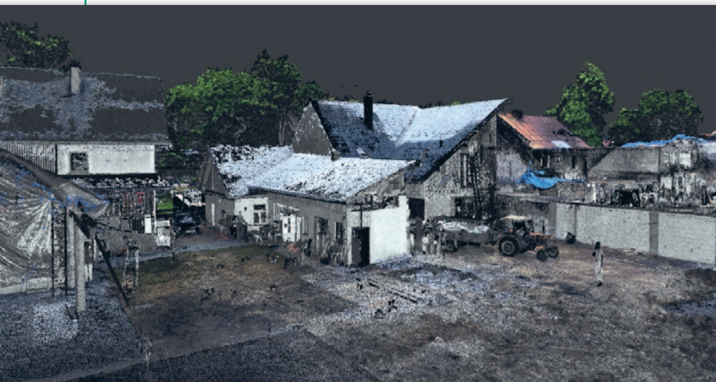
Jeden z finalnych produktów: zintegrowana chmura punktów TLS + UAV
